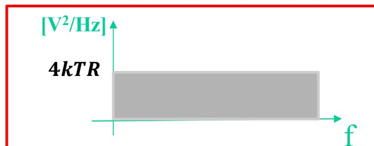
**Remarque:** Le bruit thermique en tension augmente avec T, R et la bande passante.
